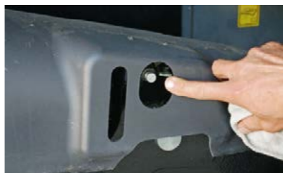
Роз'єми для регулювання гусениць також розміщені таким чином, що до них дуже просто дістатися.
