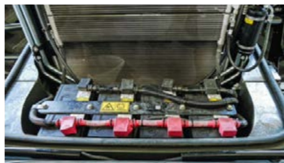
Чотири необслуговувані акумуляторні батареї забезпечують Fendt 1100 MT енергією.
