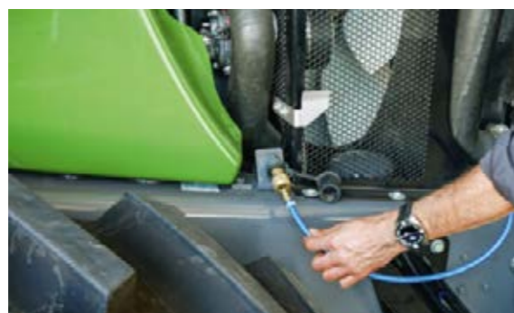
В передній частині трактора розташовано роз'єм для магістралі стисненого повітря, що потрібне для очищення радіатора.
