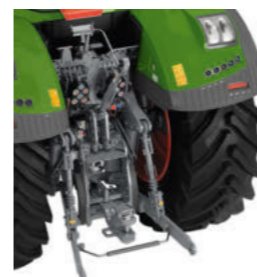
Задня навісна система з кульовими кінцями та резиновими демпферами
