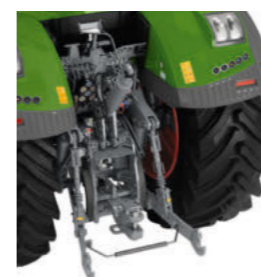
Задній навісний пристрій з автоматичним зачепами на кінцях тяг та резиновими демпферами
