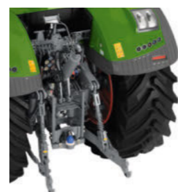
Задній навісний пристрій з автоматичним зачепами на кінцях тяг та бічними упорами
