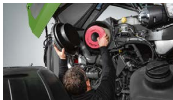
Рівень забрудненості повітряних фільтрів відображається на Varioterminal. До відсіку двигуна можна дістатися буквально за мить, знявши бічні панелі.
