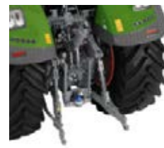
Задня навіска з швидкорознімним стопорним механізмом та бічними упорами
