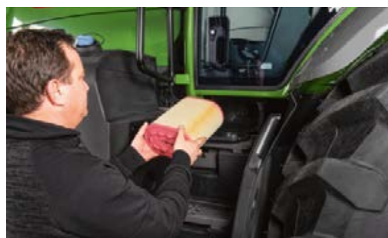
Фільтр кабіни знаходиться прямо біля дверей, його легко зняти та почистити в разі необхідності.
