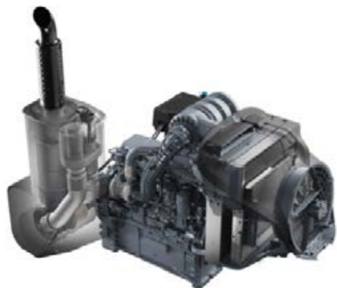
Двигун MAN об'ємом 12,4 л з паливною системою Common Rail забезпечує високий тиск впорску 1 800 бар, і тому є надзвичайно ефективним.
