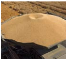
Розвантаження Streamer 210 з вмістом зерна до 17100 л здійснюється приблизно за 81 секунду.
